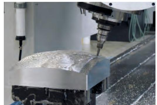
Die 30 P bietet bei großflächigen Teilen maximale Geschwindigkeit bei hoher Präzision und zeichnet sich auch Dank des 2-Achs-Schwenkkopfes durch eine hohe Einsatzflexibilität aus.
