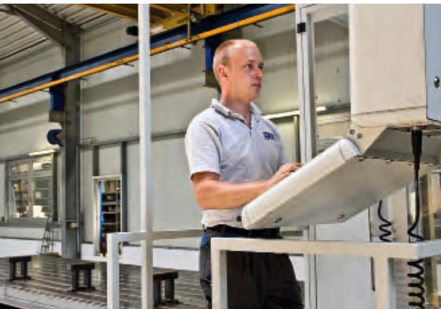
Das Bedienpult ist am Portal angebaut, so dass der Bediener immer am ‚Ort des Geschehens‘ ist.
